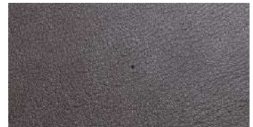
ピンホール・虫穴 生きている時に虫によってつけられた跡。また、バクテリアの繁殖などにより開いた小さな穴。
