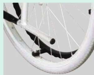
段差などで介助者が、前輪を上げる時に足をかけて踏み込むためのレバー。
