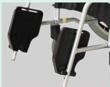
フットサポートは跳ね上げことができ、乗降時に邪魔にならないようにしたり、折りたたみの際にコンパクトにすることができます。
