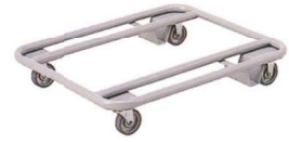
4本脚チェア用台車④ 11-424-3K ¥42,200 (W545・D700・H126) フレーム/φ25.4丸パイプ・焼付塗装(グレー) 積載能力/50kg 車輪/φ75前輪自在式
