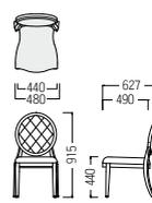
フレーム：アルミパイプ・焼付塗装(梨地加工)
