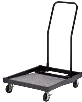
● S-OW-830 台車 ¥86,700 W645・D850・H990 本体：50×20角スチールパイプ・焼付塗装 12t合板・グレーカーペット張り φ100キャスター付き（前自在・後ろ固定） 積載有効寸法：W600・D550 総合カタログ掲載のスタッキングチェアを ほぼ全種類積むことができます。 ※積載有効寸法を確認してください。
